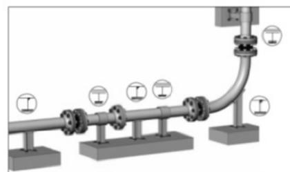
При монтаже компенсаторы не должны испытывать дополнительных нагрузок от трубопровода (изгиб, сжатие, растяжение, кручение, перекосы, неравномерность затяжки крепежа).
